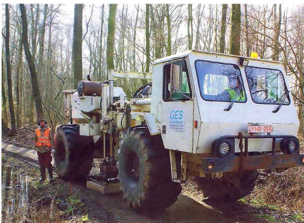
In der Mitte dieses Fahrzeuges befindet sich die Rüttelplatte, die Wellen in den Boden schickt. Die Auswertung deren Ausbreitung gibt Fachleuten dann Aufschluss über Salzvorkommen. NN-Fotos: Ingeborg Maas
