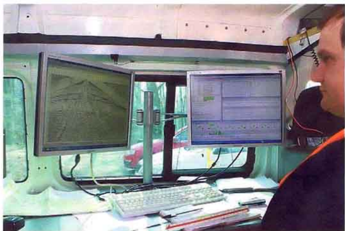
Robert Mündel erfasst in einem Bus direkt vor Ort die Signale der Energiewellen und wertet sie aus.
