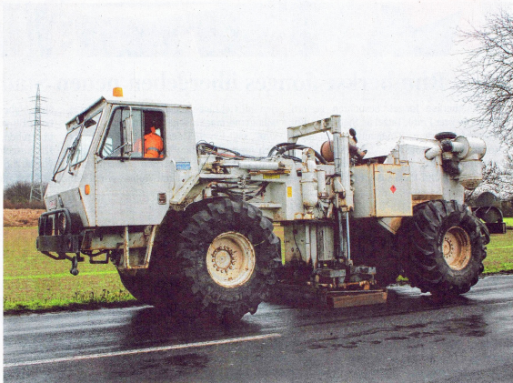
Dieses Fahrzeug wird auch nächsten Woche in Einsatz sein: Mit der Rüttelplatte, die hier gerade auf der Straße aufliegt, werden Schwingungen erzeugt, die nach der Auswertung Auskunft über die Salzvorkommen geben. FOTO: JASMIN OHNESZEIT
